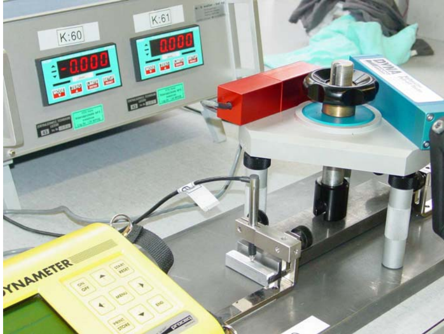
Abbildung 7: Messung der Durchbiegung der Modulhalteklammer bei unterschiedlicher Belastung
