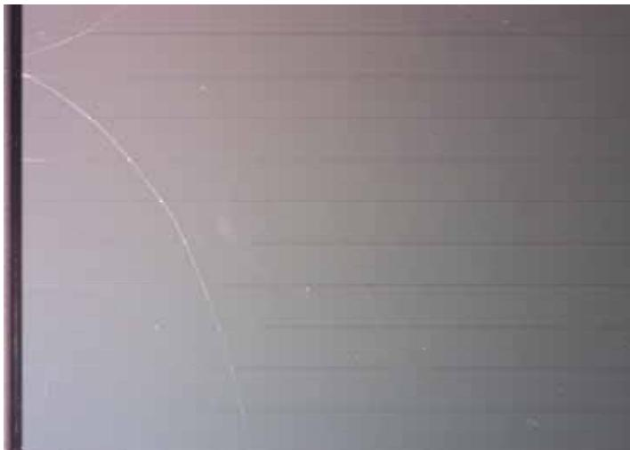
Abbildung 7-11 CIS-Modul WS11003 mit Riss im rückseitigen Substrat
