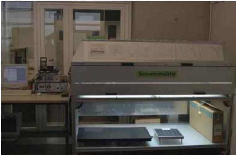
Abbildung 7-1: Sonnensimulator mit Messinterface (links)
