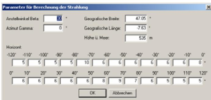
Abbildung 6-7: Ausrichtung und Horizont einer Anlage mit Grobmessung
