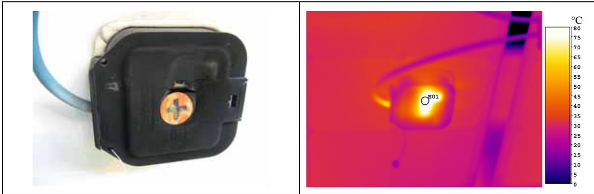
**Abbildung 4-24: Geschmolzene Anschlussdose**
