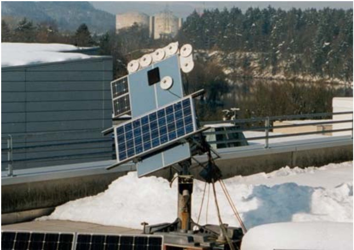
Abb. 1: Freiland-Testanlage des PSI zur Messung des Wirkungsgrades von Zellen und Modulen. Die zu testenden Module werden auf einem Sun tracker befestigt. Während einer Wirkungsgrad-Messreihe richtet der Tracker die Testmodule kontinuierlich zur Sonne aus. Zur genauen Messung der Einstrahlung auf die Module dienen sechs Pyranometer und zwei Referenzzellen (oben am Sun tracker montiert). Die Signale der Prüflinge und Einstrahlungssensoren werden ins nahe gelegene Labor geleitet, wo sie gemessen, gespeichert und verarbeitet werden. Für Vergleichszwecke ist in der oberen Hälfte, rechts noch ein neueres Pyranometer provisorisch montiert. Die Testanlage befindet sich auf dem Flachdach des Hauptgebäudes.
