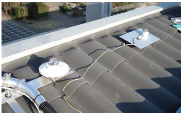
Figur 4: Pyranometer horizontal und in Modulebene
