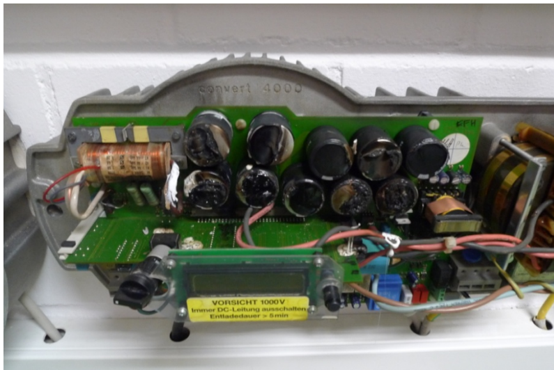
Abbildung 2-4: Vom Brand betroffener Wechselrichter Convert 4000 mit explodierten Kondensatoren.
