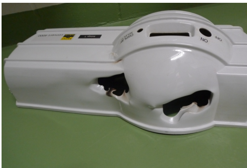
Abbildung 2-5: Durchgeschmolzenes Gehäuse des vom Brand betroffenen Wechselrichters Convert 4000.
