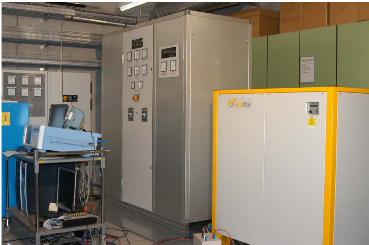
Abb. 1-2: Am PV-Labor der BFH-TI entwickelter Solargenerator-Simulator (Mitte) ( P_{MPP} \leq 101 kW, U_{OC} \leq 810 V, I_{SC} \leq 156 A) mit einem angeschlossenen Wechselrichter von 100 kW (rechts), die Messung steuerndem PC und diversen Messgeräten (links).
