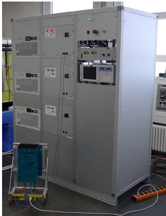
Abbildung 9: Multistring-Simulator im Testbetrieb
