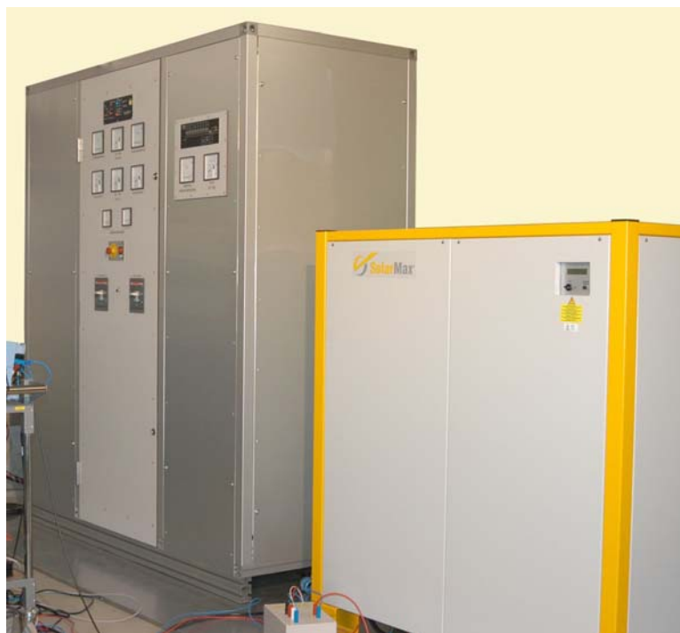
Abbildung 2: 100 kW Solargenerator-Simulator mit Prüfling
