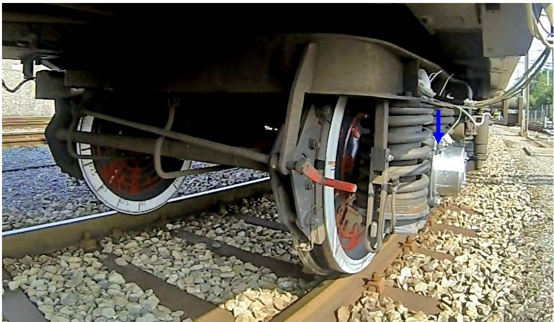
Abbildung 2-4: Messradsatz im Einsatz, Position eines Beschleunigungsaufnehmers am Achslagergehäuse (blau)
