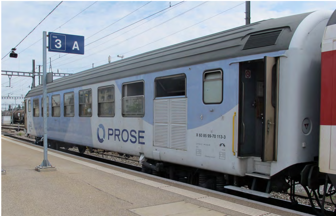
Abbildung 3-1: PROSE Messwagen 2013 mit Versuchsdrehgestell
