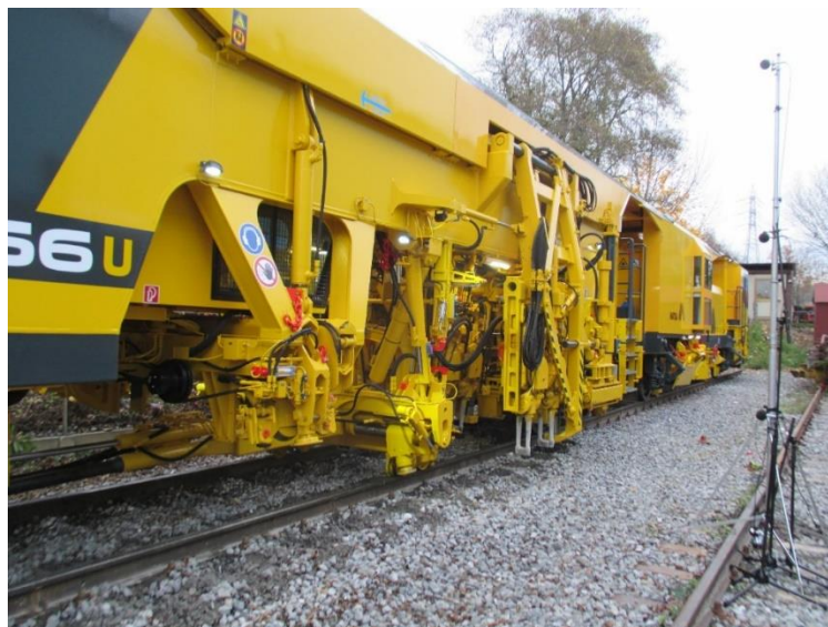
Abbildung 3-1: Messaufbau-Luftschallmessungen an der Stopf- und Verdichtungseinheit
