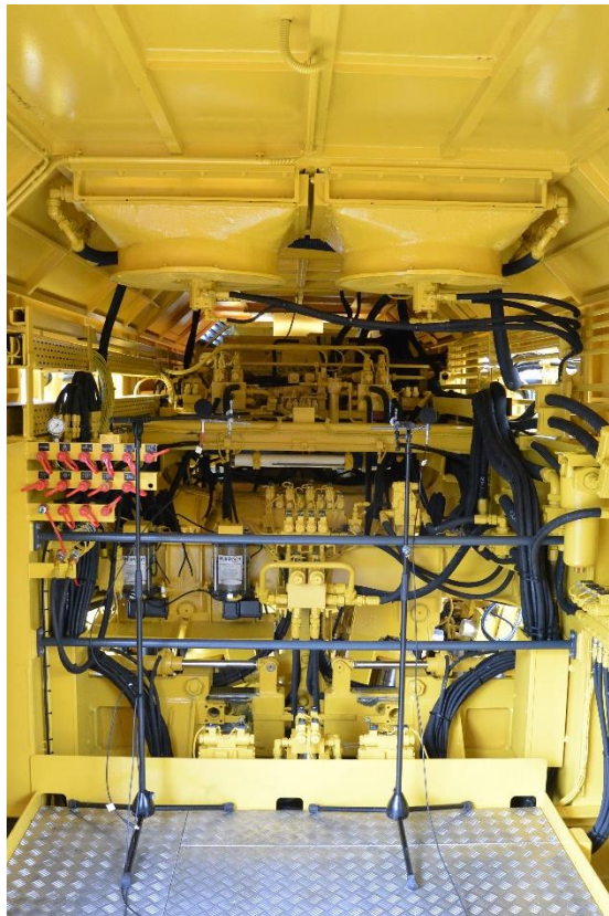
Abbildung 3-34: Messaufbau-Nachhallmessungen im Innenraum im Bereich der Stopfeinheit
