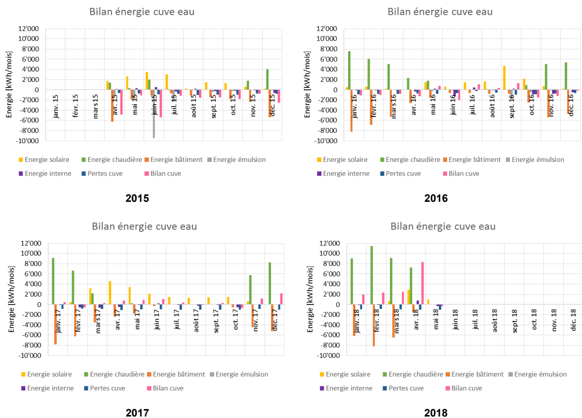
Figure 75 : Cuve d'eau – répartition des énergies entrantes et sortantes
