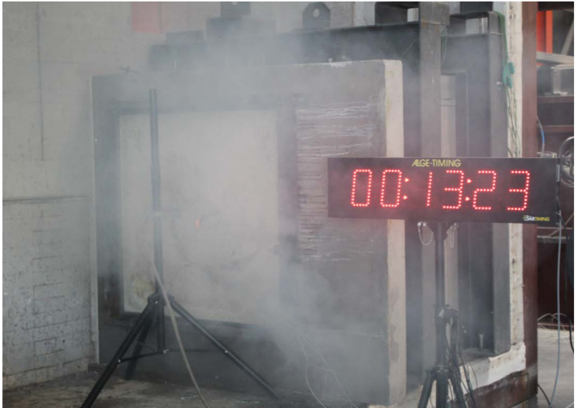
Abb. 7 Aufsicht auf die Versuchsanordnung bei Glas Trösch mit eingesetztem Brandschutzglas als Prüfkörper
