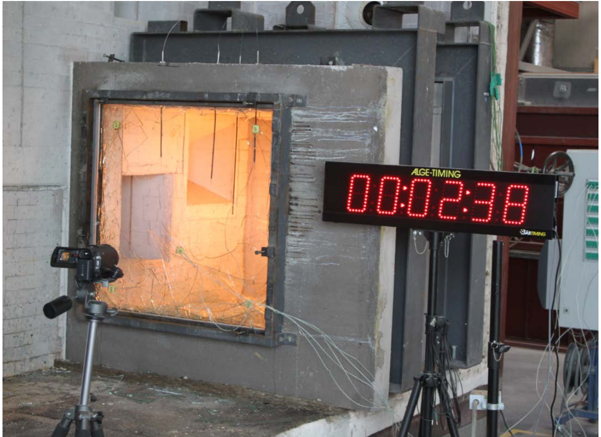
Abb. 10 Aufsicht auf die Versuchsanordnung bei Glas Trösch mit eingesetztem 3-fach Isolierglas als Prüfkörper.
