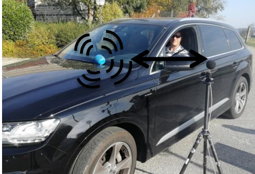
Abbildung 4: AVAS Standmessungen für Vergleichbarkeit der Emissionen des simulierten AVAS mit allen Fahrzeugen.
