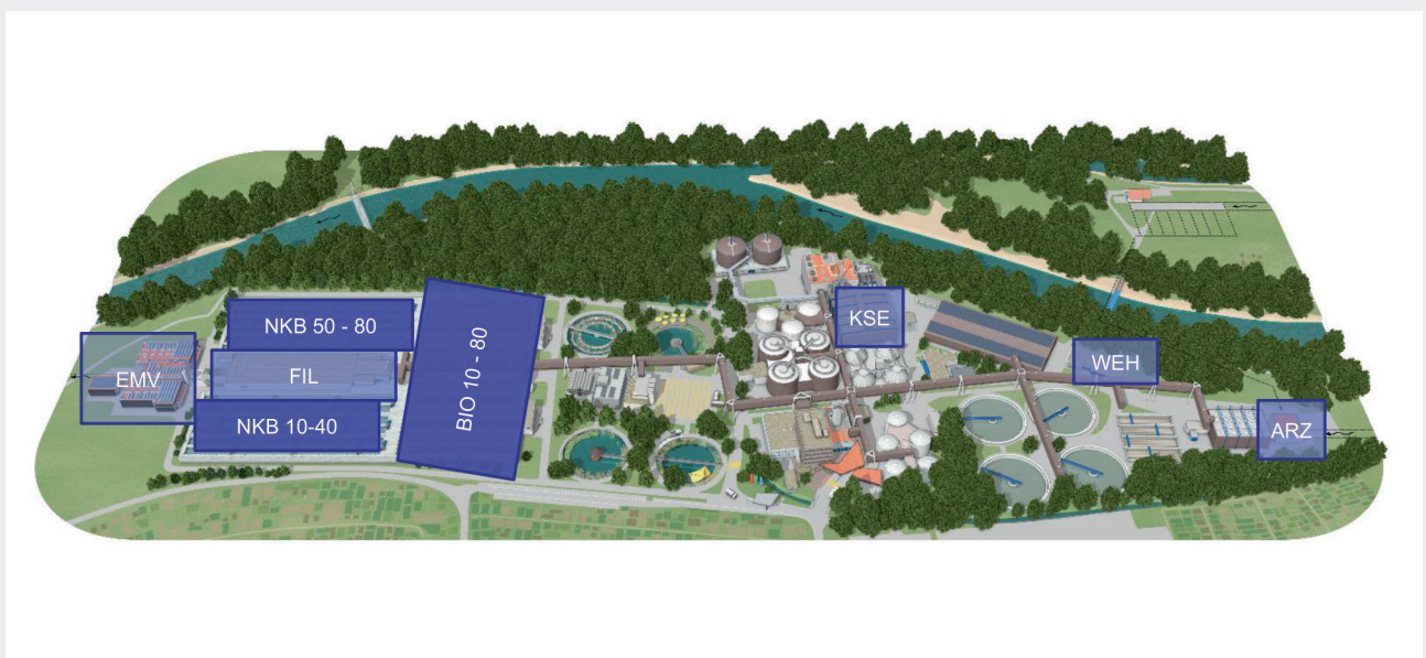
Fig. 3 Eine Studie auf dem Klärwerk Werdhölzli zeigte verschiedene mögliche Standorte für Photovoltaikanlagen mit einem Potenzial von 4000 kWp auf.
