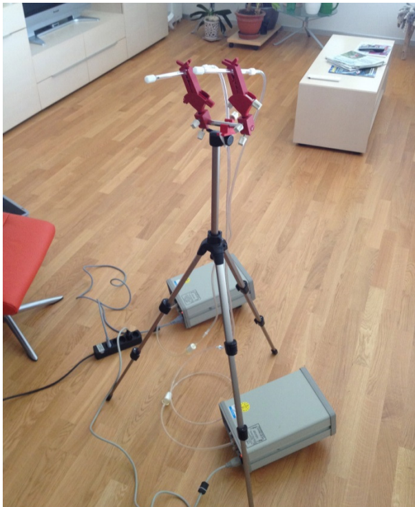
Abbildung 19: Installationsaufbau für die VOC-Messung
