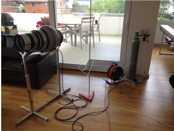
Abbildung 20: Installationsaufbau für die Tracergas-Messung
