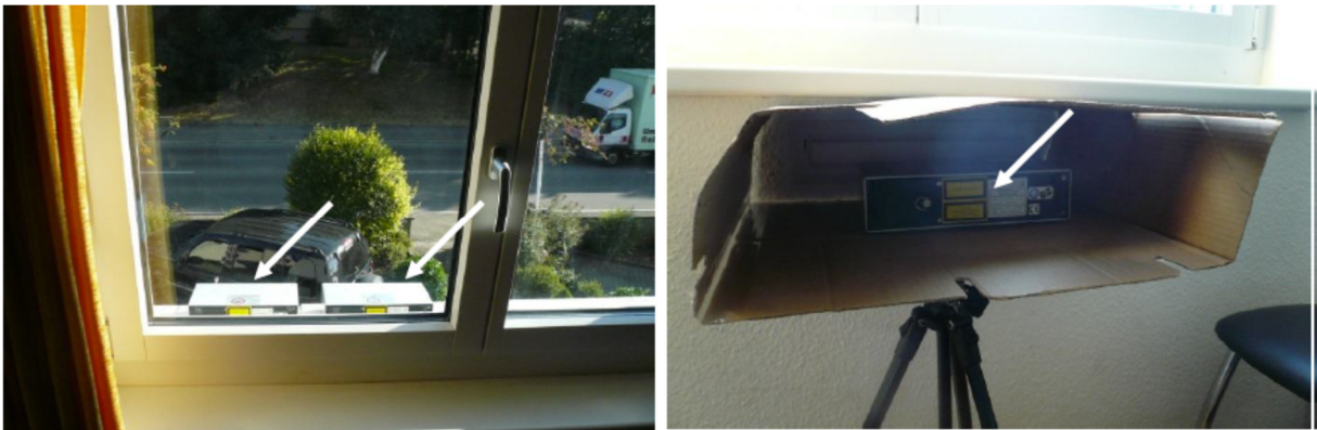
Abbildung 17: Partikelmessung Aussen (inkl. Referenzmessung) / Partikelmessung Zuluft Schlafzimmer
