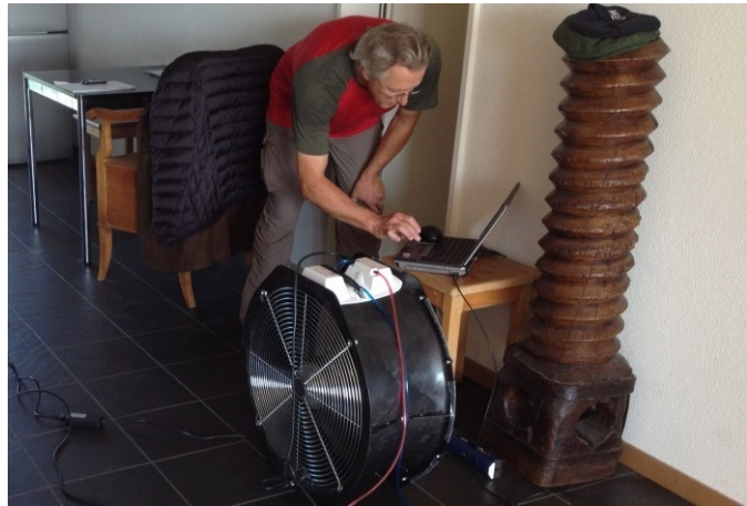
Abbildung 14: Einstellung des Blower Door-Tests in untersuchter Wohnung
