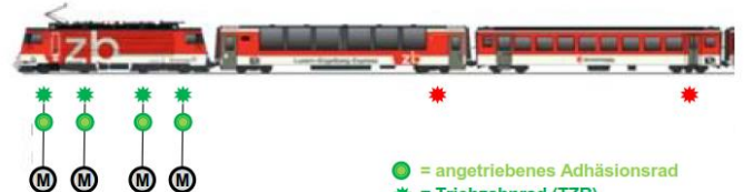
Abbildung 5: Antriebskonzepte der wichtigsten bei der zb verkehrenden Zahnradfahrzeuge
