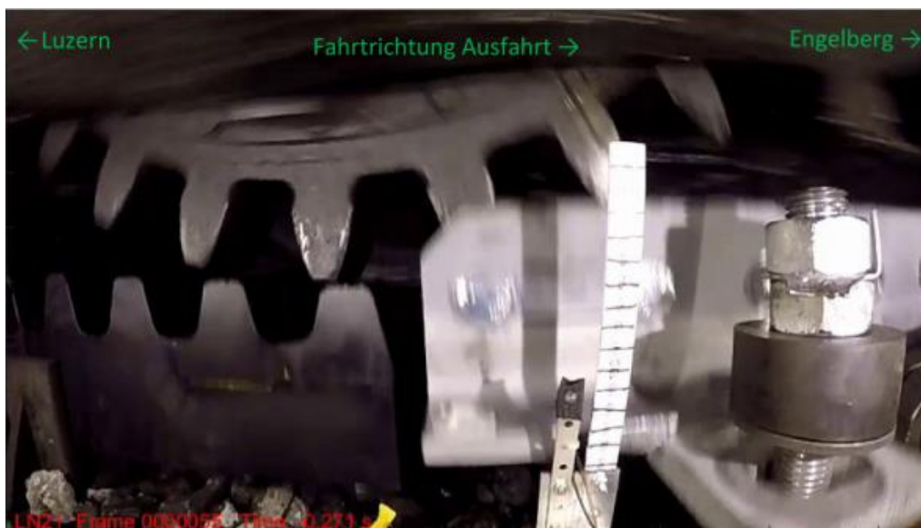
Abbildung 9: Video-Beweis des De-Synchronisiervorgangs bei der Ausfahrt: das Triebzahnrad der HGe läuft Kopf-auf-Kopf aus der Lamelle (links) aus und trifft systematisch die erste Rolle des Rollenbalkens (rechts). Die hiermit ausgelöste Biegewelle führt zu sehr hohen Spannungen und Ermüdungsschädigung im Rollenbalken.
