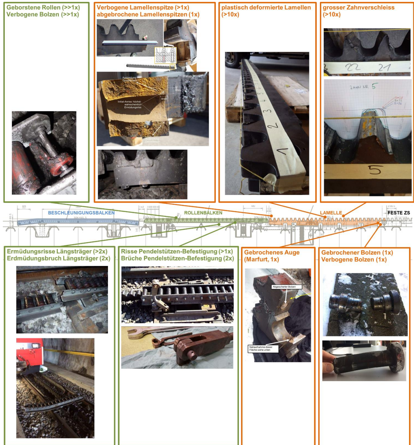
Abbildung 6: Wichtigste Schadensbilder an Zahnstangeneinfahrten der Zentralbahn. Die Bilder zeigen mit 1 Ausnahme Schadenfälle aus den Jahren 2015-2017.
