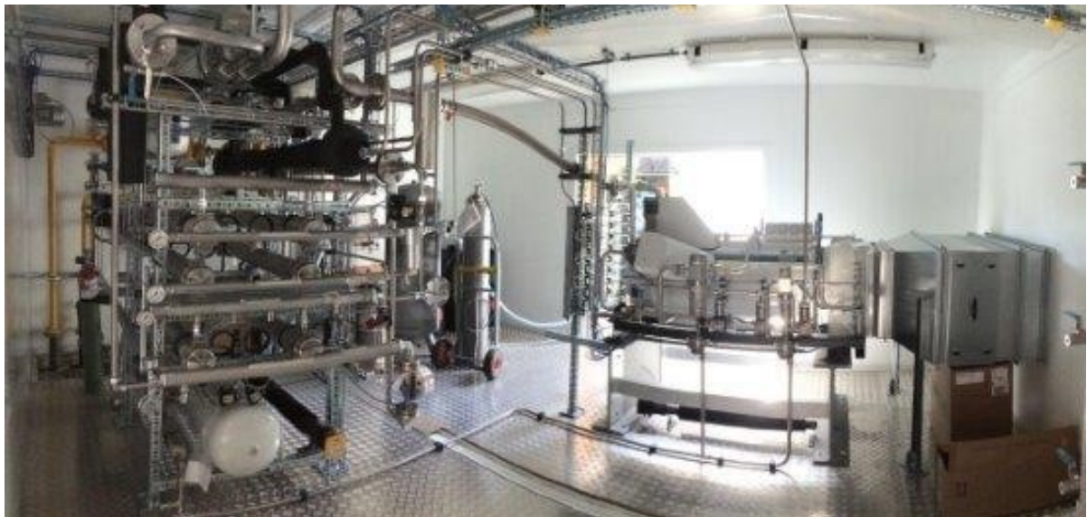
Abbildung 3: Innenansicht der Container (Ex-Zone) mit dem Verdichter (rechts) und dem Aufbereitungsmodul (links).
