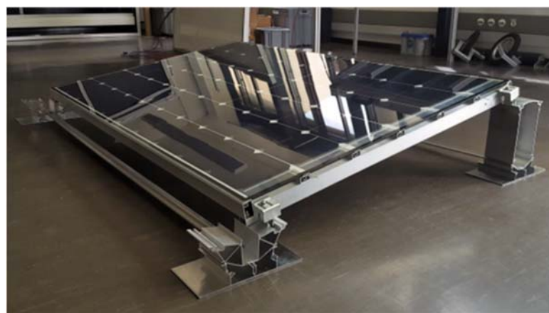
Abbildung 18: Leichtbaumodul mit rückseitiger Gitterstruktur (7 Längsträger, ein Querträger) auf einer Unterkonstruktion des Herstellers Schweizer Metallbau welche für den Einsatz auf Flachdächern vorgesehen ist. Der Vorteil von Leichtbaumodulen bleibt bei dieser Form der Aufständerkonstruktion auf geringere Transportkosten und leichteres Handling der Module vor Ort beschränkt. Die Unterkonstruktion wurde von Schweizer Metallbau gestellt.
