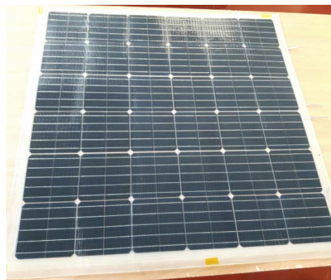
Abbildung 9: Sehr leichte und vergleichsweise robuste Module konnten durch Verwendung von GFK-Platten als Trägermaterial aufgebaut werden. Als Frontmaterial wurden transparente Backsheets von Solinex Isovoltaic und ETFE-Folien eingesetzt.
