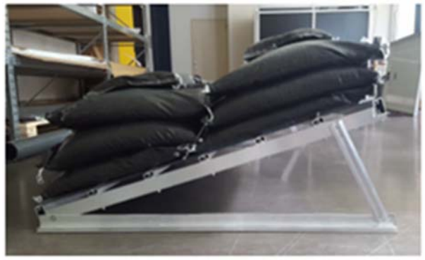
Abbildung 21: Auch an der Kombination aus Unterkonstruktion und Leichtbaumodul wurden Tests mit Lasten bis zu 480 kg durchgeführt.
