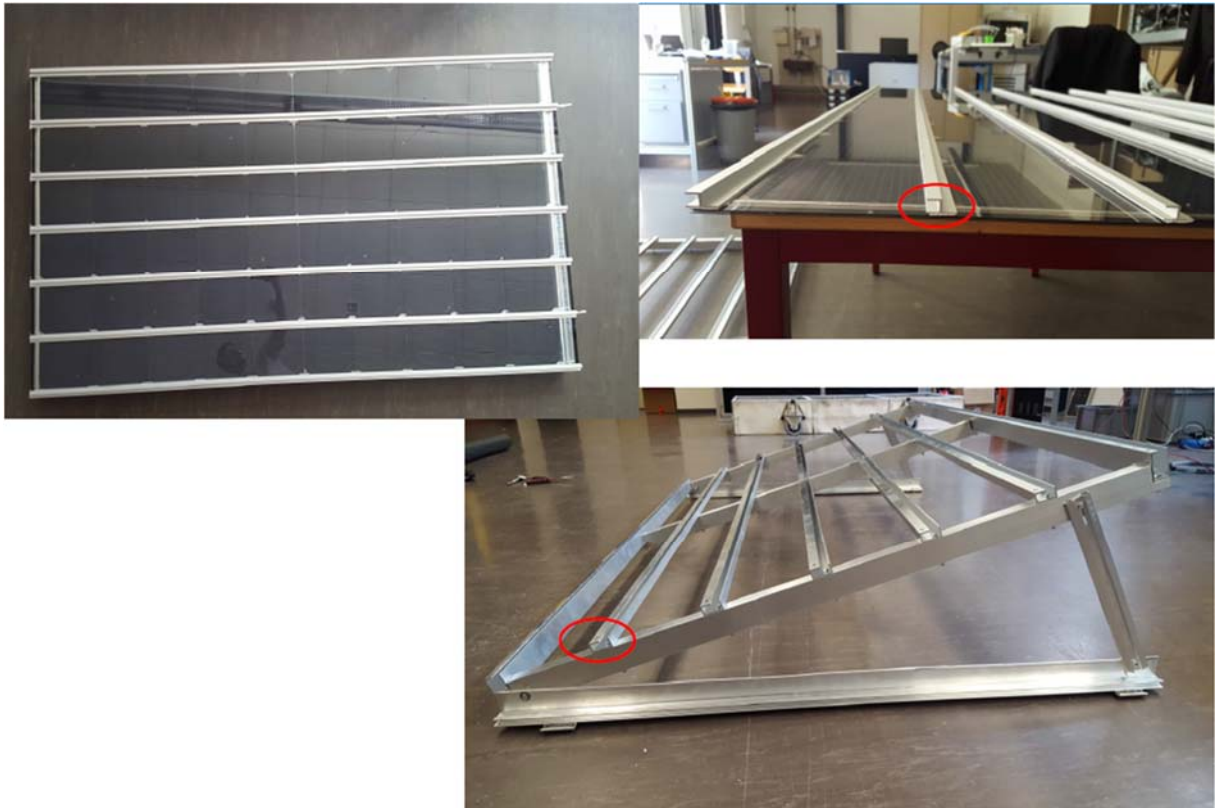
Abbildung 20: Im Unterschied zu den bisher getesteten Varianten wurden keine durchgehenden rechteckigen Profile, sondern offene C-Profile eingesetzt. Bei diesem Ansatz werden jeweils C-Profile, welche sowohl am Modul wie auch an der Unterkonstruktion befestigt sind, bei der Montage durch einfaches Einlegen ineinander gehakt.
