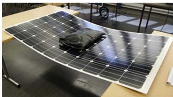
Abbildung 10: Glas/Backsheet Laminat mit 2 mm Glas bei moderater Belastung (links) und 0.8 mm Glas mit aufgelegter Zellenmatrix ohne jede zusätzliche Belastung (rechts).
