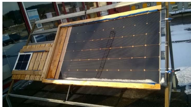
Abbildung 24: Auf einem improvisierten Stand (rechts) für ein Glas/Glas- sowie für zwei glasfreie GFK/ETFE-Module (hier nur ein Platz belegt) wurden die Module Outdoor-Bedingungen ausgesetzt, aber nicht elektrisch angeschlossen. Links ist ein Glas/Backsheet-Modul mit 0.8 mm Glasdicke auf der im Projekt entwickelten Gitter-Unterkonstruktion. Die Module wurden zur Vermessung mehrfach ins Labor transferiert.
