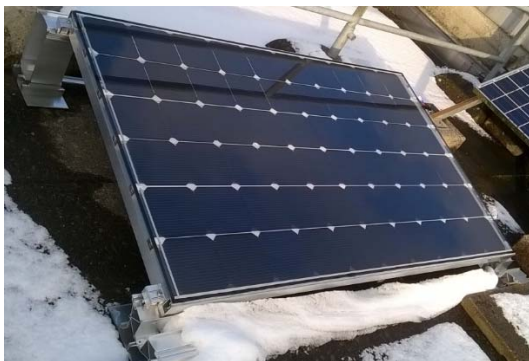
Abbildung 24: Auf einem improvisierten Stand (rechts) für ein Glas/Glas- sowie für zwei glasfreie GFK/ETFE-Module (hier nur ein Platz belegt) wurden die Module Outdoor-Bedingungen ausgesetzt, aber nicht elektrisch angeschlossen. Links ist ein Glas/Backsheet-Modul mit 0.8 mm Glasdicke auf der im Projekt entwickelten Gitter-Unterkonstruktion. Die Module wurden zur Vermessung mehrfach ins Labor transferiert.
