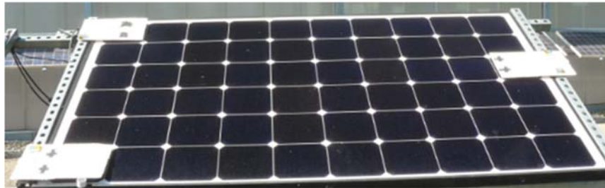
Abbildung 30: Outdoor-Abschattungsdauertest mit grossem 60-zelligem Modul, hier in monofacialer Modulkonfiguration. Im Fokus stehen hier potentielle Schädigungen, Leistungseinbussen sind bei Abschattung einzelner Zellen nur schwer zu detektieren.
