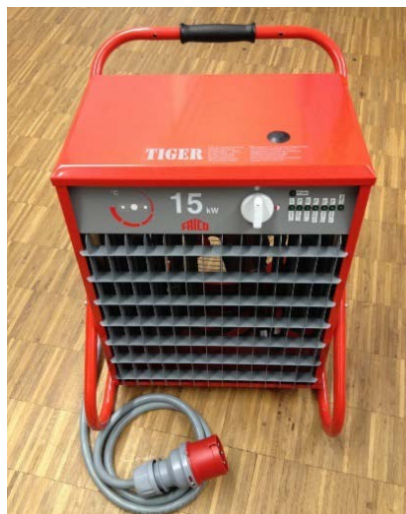
Abbildung 12: Modifizierter Heizlüfter als 'elektronische' Last
