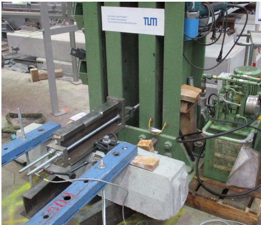
Abbildung A.2: Bestimmung des Durchschubwiderstandes
