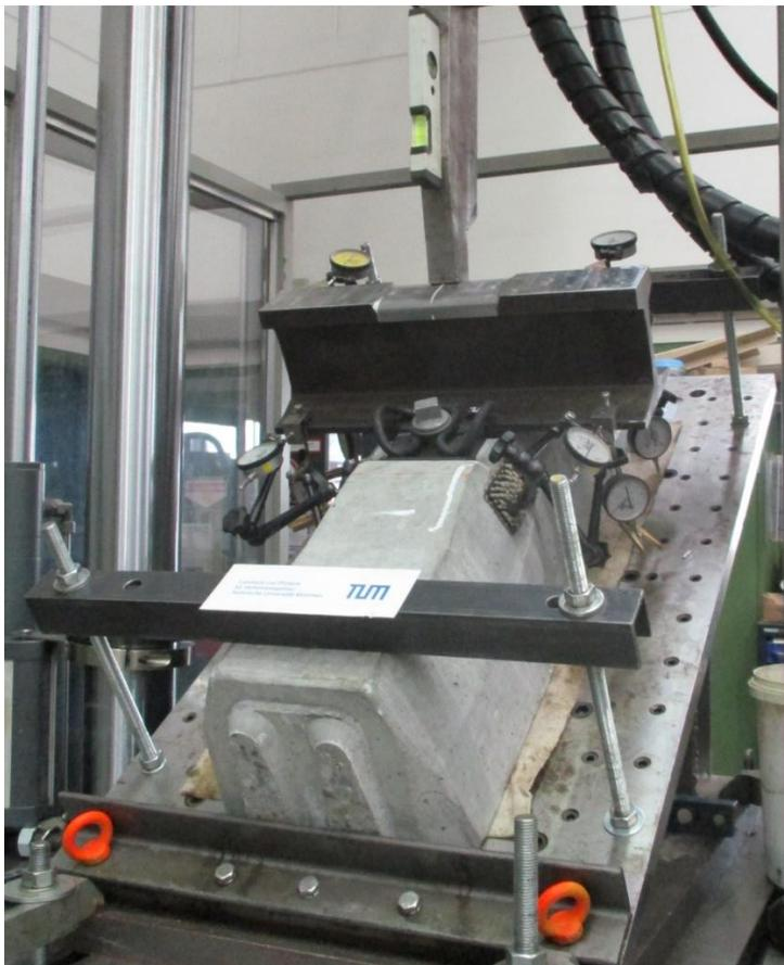
Abbildung A.4: Dauerschwingversuch,  $\alpha = 33^\circ$ ,  $P_V/\cos \alpha = 75 \text{ kN}$ ,  $X = 15 \text{ mm}$
