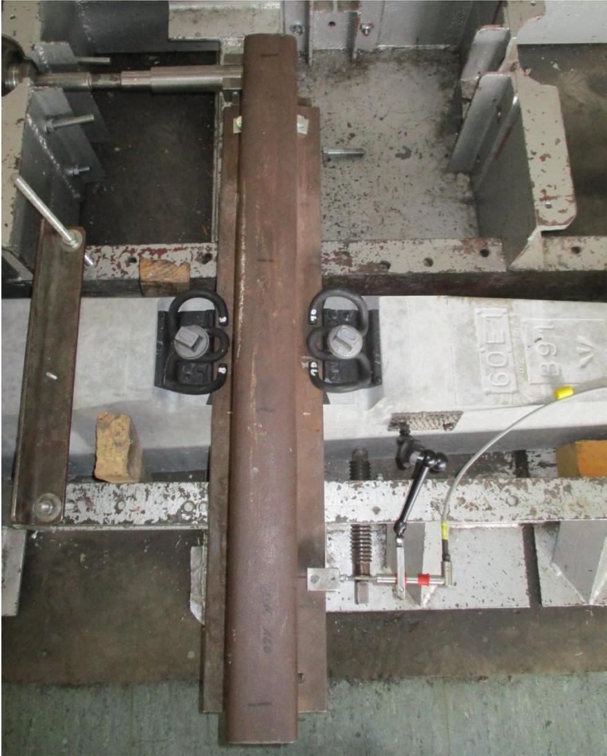
Abbildung A.7: Bestimmung des Verdrehwiderstandes
