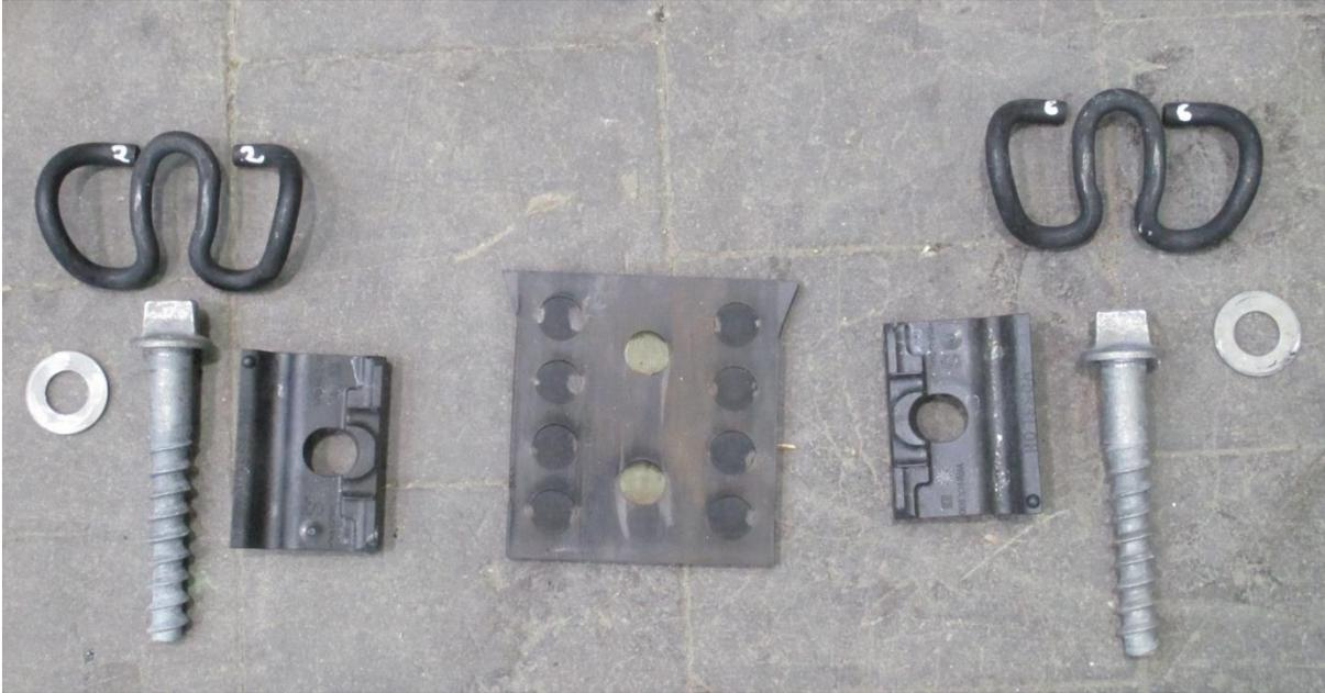
Abbildung A.5: Schienenbefestigungskomponenten (demontiert) nach dem Dauerversuch
