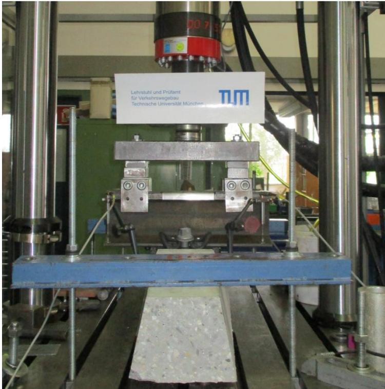
Abbildung A.3: Bestimmung der vertikalen Stützpunktsteifigkeit
