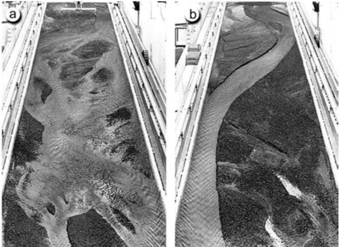
*Bild 1 Veränderung eines Gewässers mit verzweigter Gerinneform (a) zu einem gewundenen Gerinne (b) nach dem Durchgang einer Hochwasserwelle mit auf 20% reduzierter Geschiebezufuhr. Physikalischer Modellversuch von Marti an der Versuchsanstalt für Wasserbau, Hydrologie und Glaziologie der ETH Zürich (Marti C. und Bezzols G.R., 2004).*
