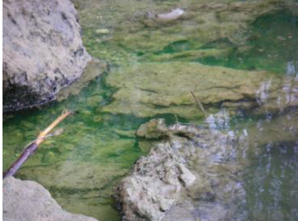
Abbildung 27 Markierversuch im März 2011 bei der Deponie Les Frêtes (NE) im Rahmen der technischen Untersuchungen nach AltIV: Fotos des eingespeisten Farbstoffs (links) und der Rückgewinnung an der Unterwasserquelle Les Bains im Doubs, zwei Tage nach der Einspeisung. Nach (MFR, 2011).
