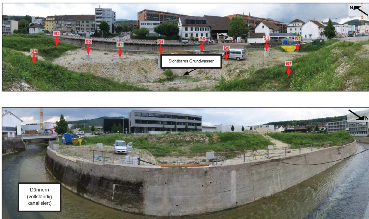
Abbildung 6 Panoramafotos vom Türler-Areal in Olten und Position der Brunnen und Bohrlöcher, die für den Immissionspumpversuch verwendet wurden. Das Bohrloch B1 wurde für den Pumpversuch verwendet. Die Überwachung wurde an den auf dem Foto mit einem roten Pfeil markierten Stellen durchgeführt (Tomson, 2016).
