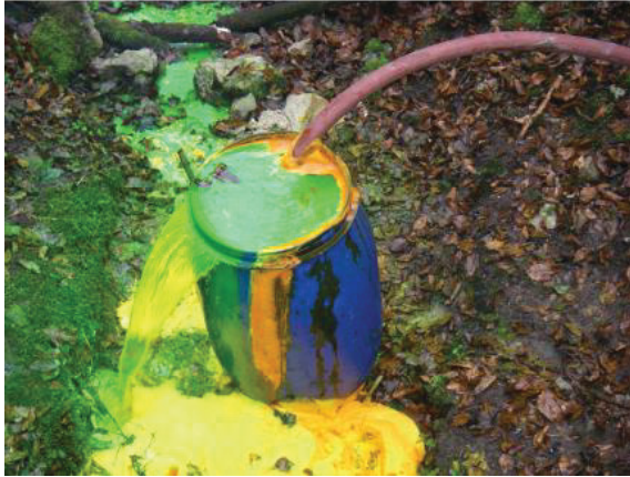
Abbildung 27 Markierversuch im März 2011 bei der Deponie Les Frêtes (NE) im Rahmen der technischen Untersuchungen nach AltIV: Fotos des eingespeisten Farbstoffs (links) und der Rückgewinnung an der Unterwasserquelle Les Bains im Doubs, zwei Tage nach der Einspeisung. Nach (MFR, 2011).
