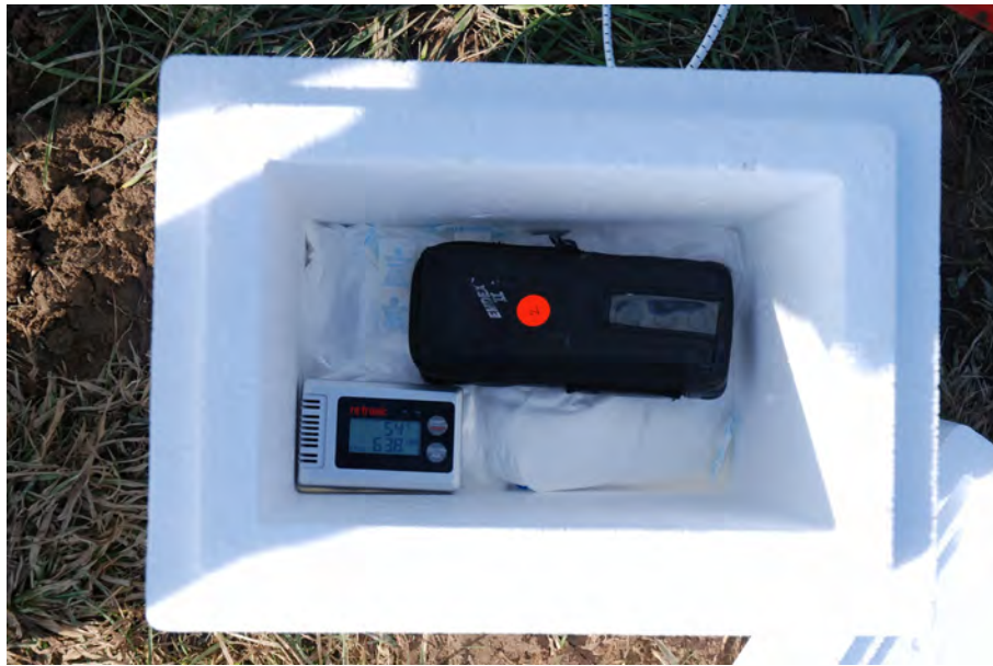
Abbildung 5: Geöffnete EPS-Messkiste mit Emdex II (im schwarzen Lederetui mit dem roten Punkt) und Temperaturlogger (links unten). Darunter die (grossen) Beutel mit PX05 und (kleine) Beutel mit Silicagel. Das ganze wird noch zugedeckt mit weiteren Beuteln von PX05 und dem Deckel der Kiste.
