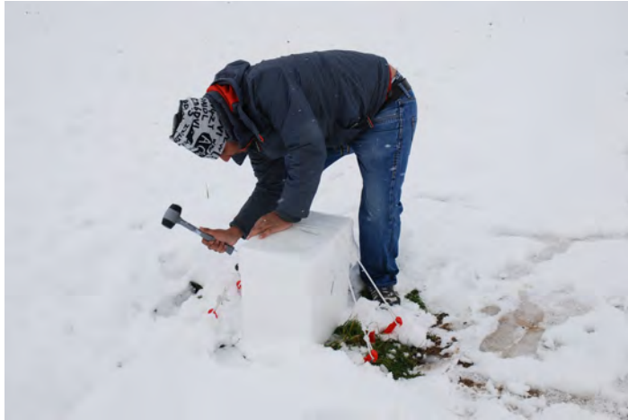
Abbildung 4: Fixieren der Messkiste am Boden
