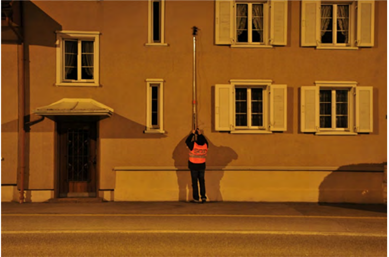
Bild: Messungen der vertikalen Beleuchtungsstärke mittels Teleskopstange
