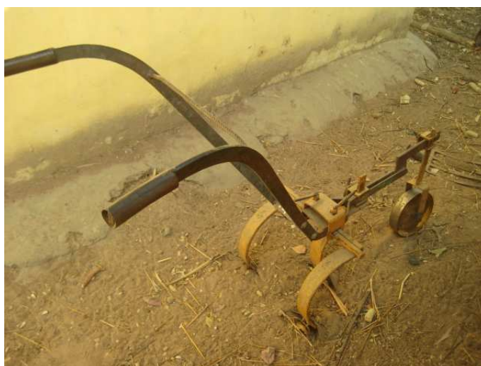
Le model de charrue simple pour la traction animale
