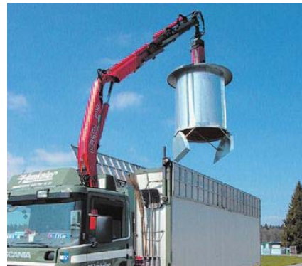
Abbildung 8: Entleerung Halbunterflursystem ( http://www.abfall-systeme.de )
