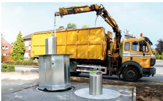
Abbildung 9: Anheben Unterflurcontainer ( http://www.entsorgungstechnik.ch )
