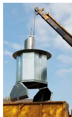
Abbildung 10: Entleeren Unterflurcontainer ( http://www.entsorgungstechnik.ch )
