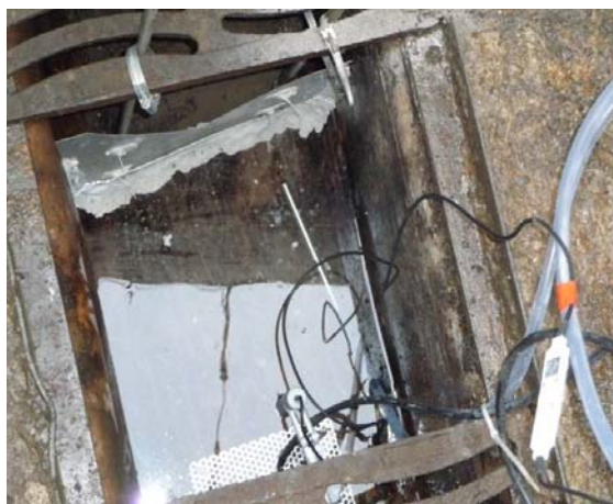
Abb. 3 Installation im Kontrollschacht der Sickerwasserleitung am RBL (Fließrichtung von unten nach oben). Oben das Wehr aus Aluminiumblech (V-förmig eingeschnitten), unten Lf-Sonde und Lochblech zur Befestigung der Ultraschallsonde sowie Pumpschlauch und Zuleitungskabel für die Sensoren.
