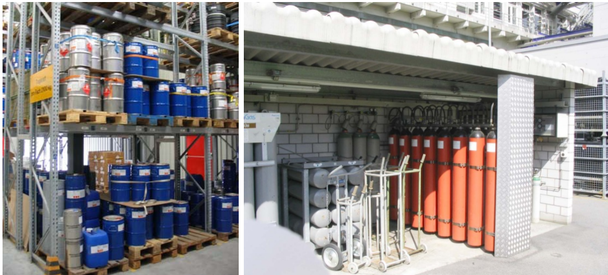
Abb. 21: Erdbebengerechte Lagerung von Waren, a) durch Zusammenbinden der Paletten und Gebinde, b) gegen Umfallen gesicherte Gasflaschen (Foto Studer)
