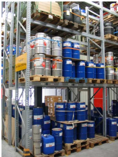
Abb. 5.14: Erdbebenerechte Lagerung von Waren durch Zusammenbinden der Paletten und Gebinde (Foto Studer)
