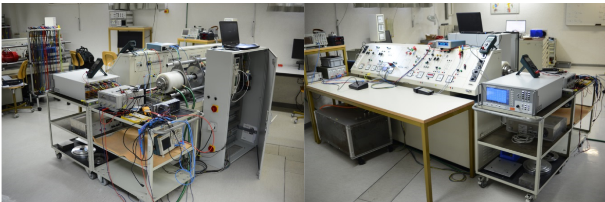
Figure 13 Photos du montage du moteur de l'hydrolienne sur le banc de test du laboratoire de machines électriques, réf [8].
