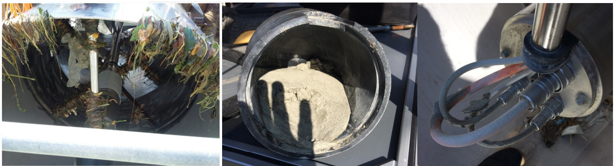
Figure 32 Illustration de l'impact de l'environnement sur l'hydrolienne (algue, herbe, sédiment), réf [13].
