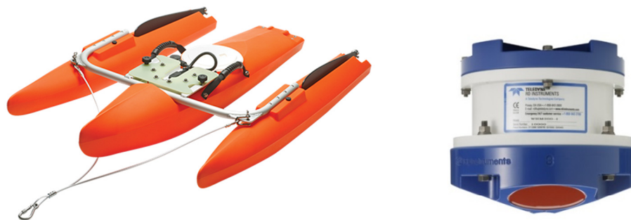
Figure 17 Appareil de mesure du champ de vitesse : Petit catamaran équipée d'un système ADCP de mesure et d'un transmetteur de données à distance par Bluetooth.
