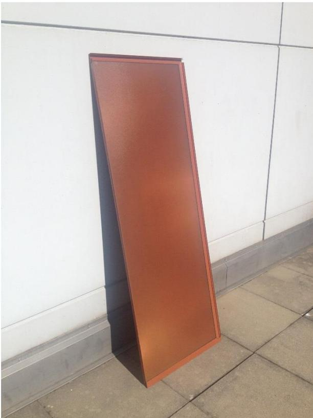
**Figur 12:** *Erstes funktionsfähiges Muster mit 27 Solarzellen und farbiger Bedruckung*
