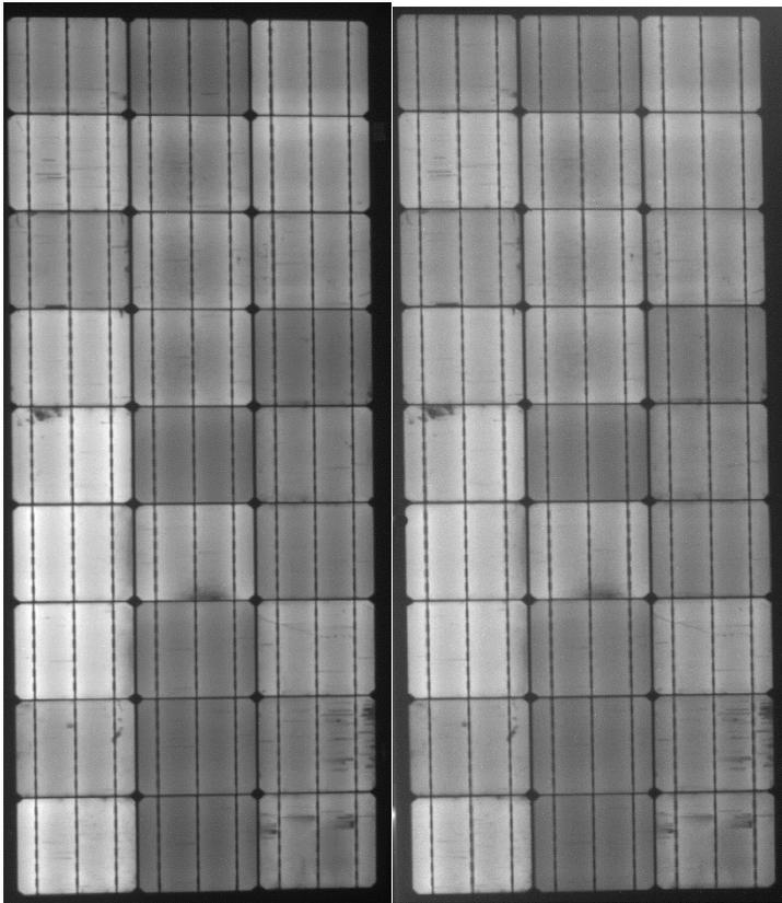
**Figur 11:** Elektrolumineszenz-Aufnahme des Glas-Glas « Terrakotta »-Moduls vor (links) und nach (rechts) erfolgtem Thermocycling
