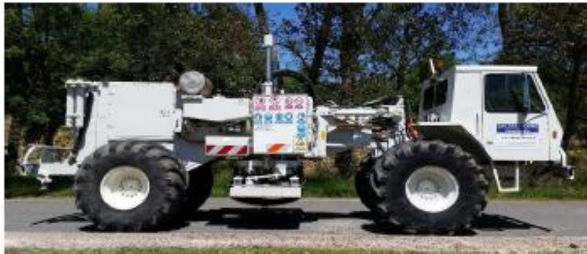
Figure 7: exemple de camion vibreur (source : Geo2X SA)
