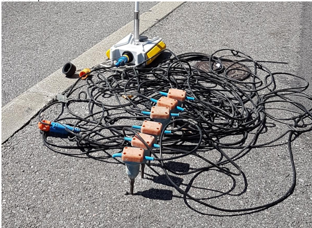
Figure 8: une bretelle de géophones implantée lors de la campagne SiL-2016 (source : Geo2X SA)
