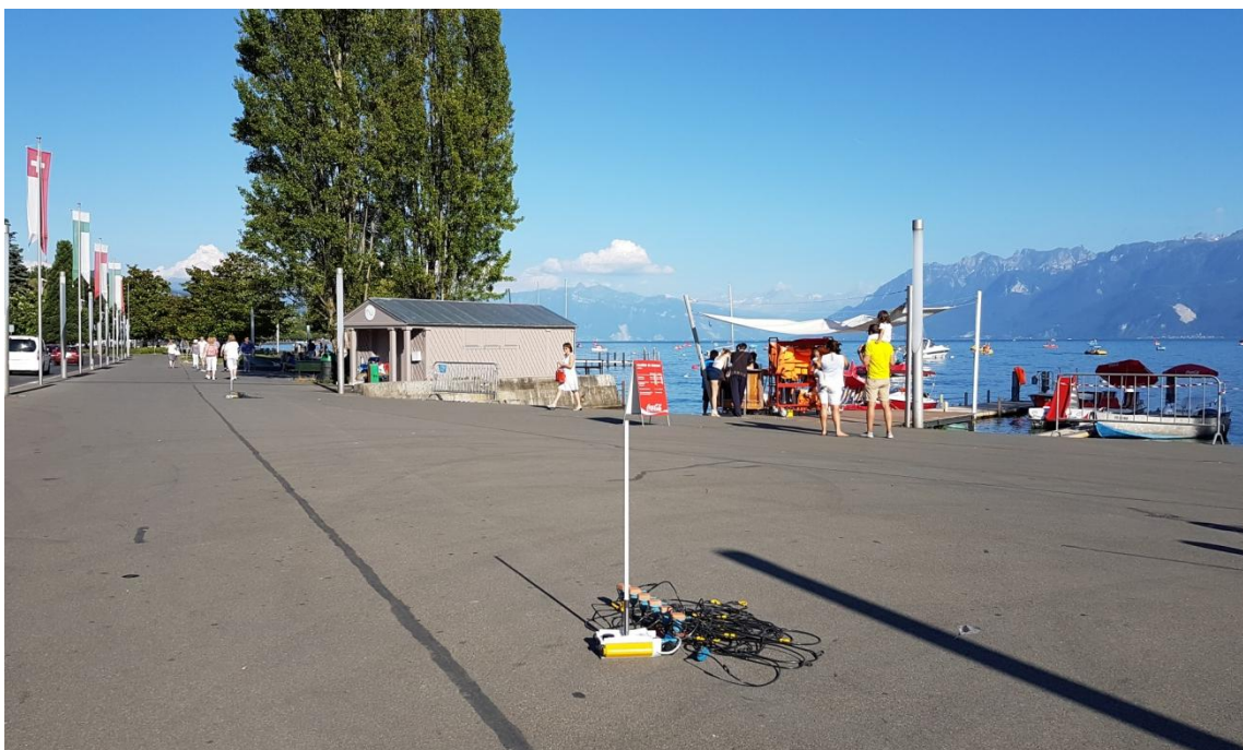
Figure 9: bretelle de géophones reliée a un sismographe sans fils (source : Geo2X SA)
