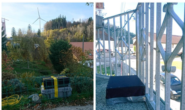
Figure 3: Photographies des points de mesure LUS Nord (à gauche) et LUS Sud (à droite). Le microphone extérieur est situé dans une cagette recouverte d'un tissu acoustique.
