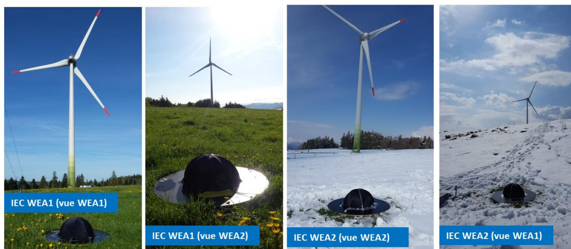
Figure 2: Photographies des points de mesure de type IEC61400-11
