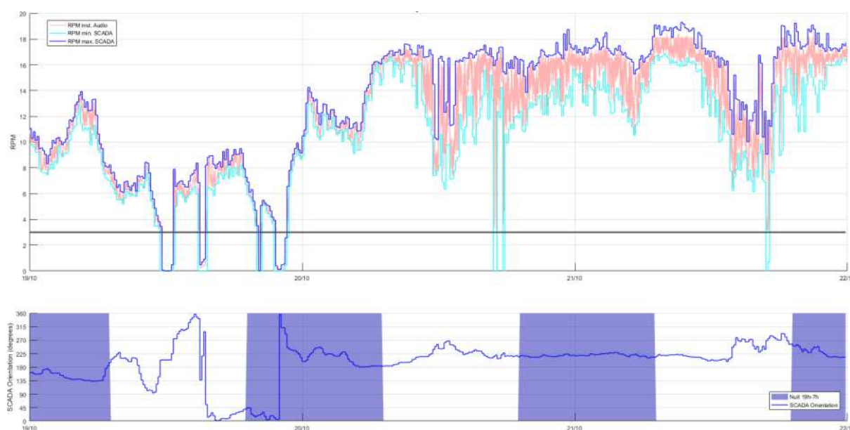
Figure 16: Evaluation de la vitesse de rotation instantanée par analyse audio. En bleu et cyan les valeurs max et min des données SCADA; en rose les valeurs RPM instantanées issues du traitement audio.
