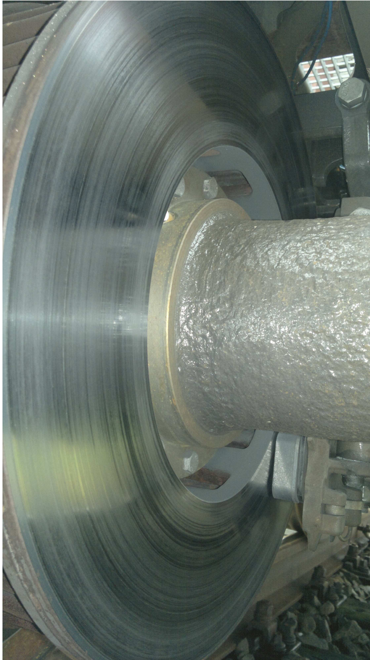
Abbildung 17 – Bremsscheiben nach dem durchgeführten Gotthardttest
