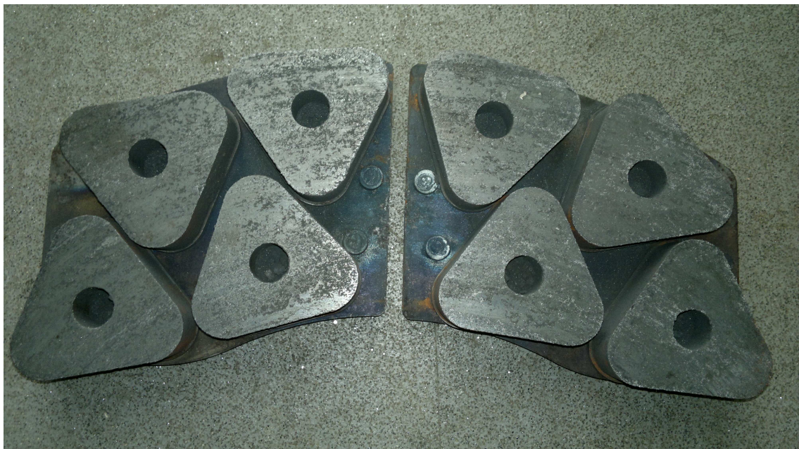
Abbildung 16 – Bremsbelag nach dem durchgeführten Gotthardtest
