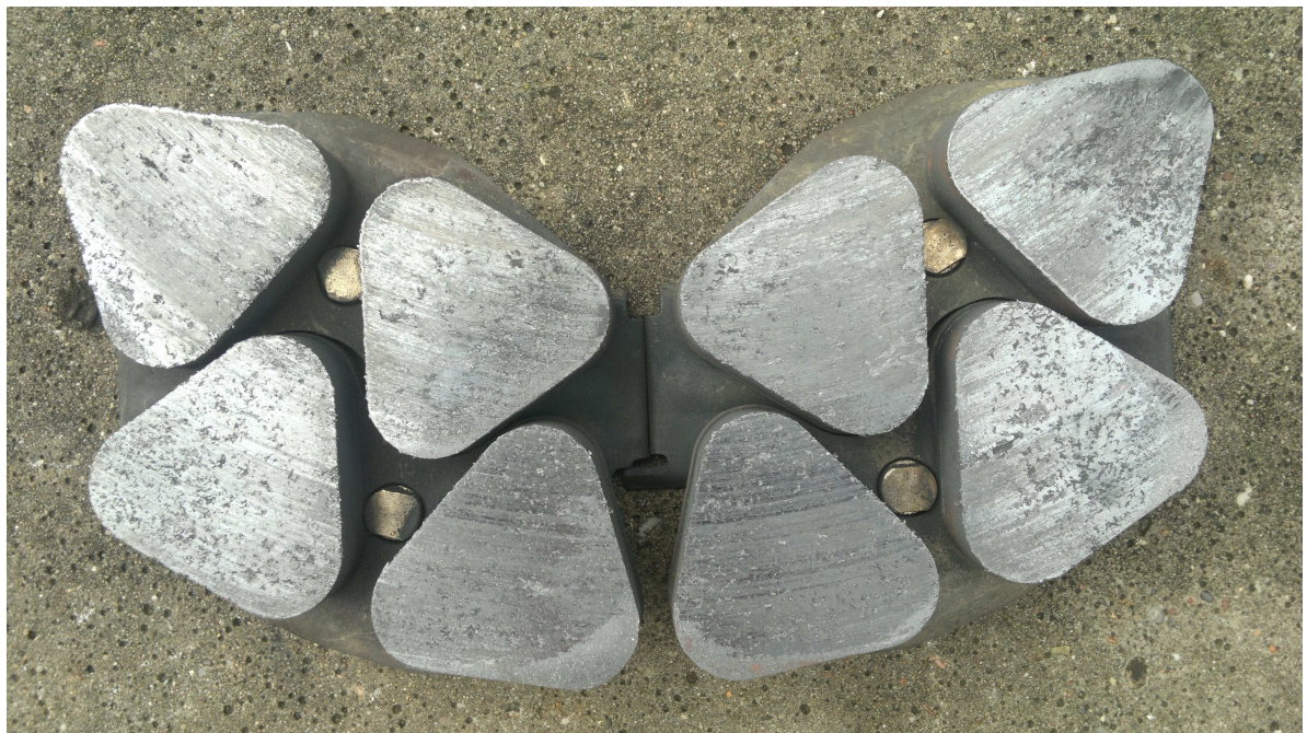
Abbildung 16 – Bremsbelag nach dem durchgeführten Gotthardtest
