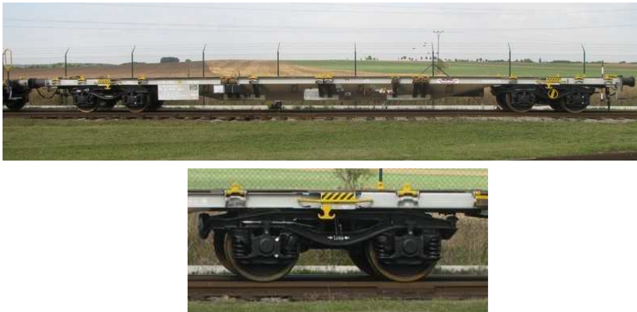
Abb. 4 – Containertragwagen Gattung Sgnss, Scheibenbremse, ohne Beschichtung
