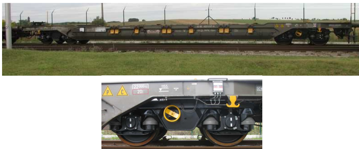
Abb. 5 – Taschenwagen Gattung Sdgnss, Scheibenbremse, mit Beschichtung
