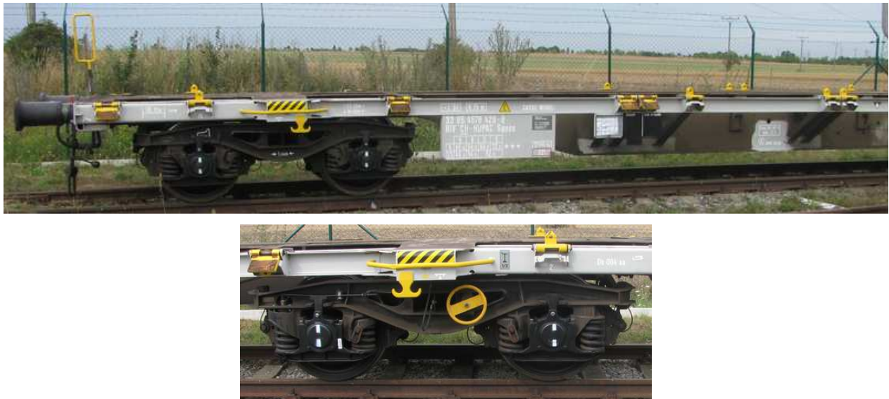
Abb. 7 – Containerwagen Gattung Sgnss, Klotzbremse, ohne Beschichtung
