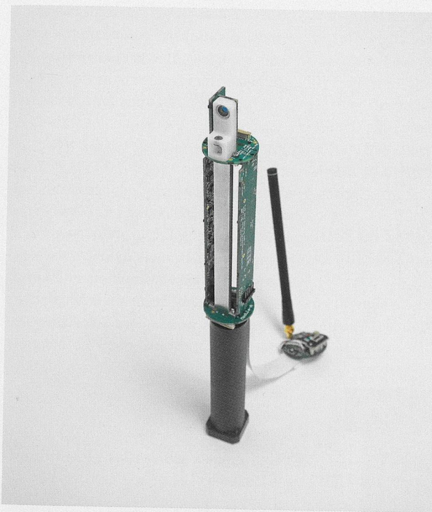
Fig. 5 Electronique de la sonde (à gauche) et sonde complète (à droite) Elektronik der Sonde (links) und Gesamtansicht der Sonde (rechts)
