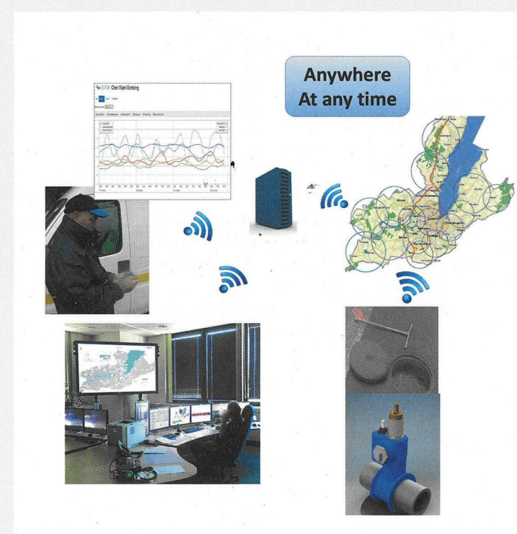
Fig. 1 Schéma de principe global du projet «Clean Water Monitoring». Il s'agit d'un projet de développement d'une sonde de mesure multi-paramètres permettant de suivre en temps réel l'évolution de la qualité de l'eau potable.
