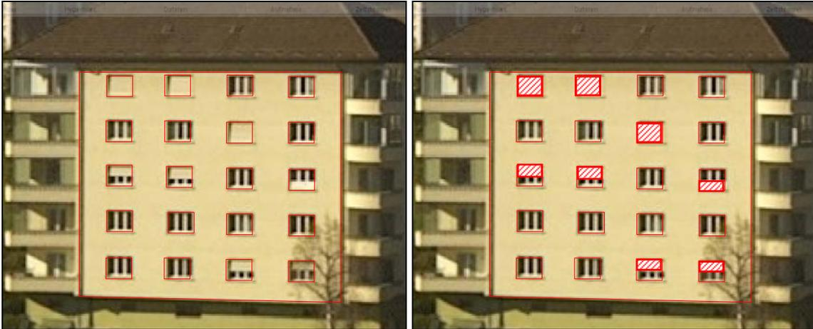
Abbildung 7 Mehrfamilienhaus mit Rollläden mit Fenstermaske, mit Direktstrahlung; Anteil verschattete Fenster im Beispiel: 5.5 von 20 Fenstern sind verschattet = 28%, Fensteranteil Fassade = 19%, Glasanteil Fassade = 15%
