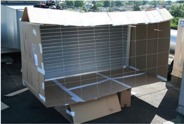
Figure 66. Système de mesure du débit de ventilation et résultats (installation Eaux-Vives).
