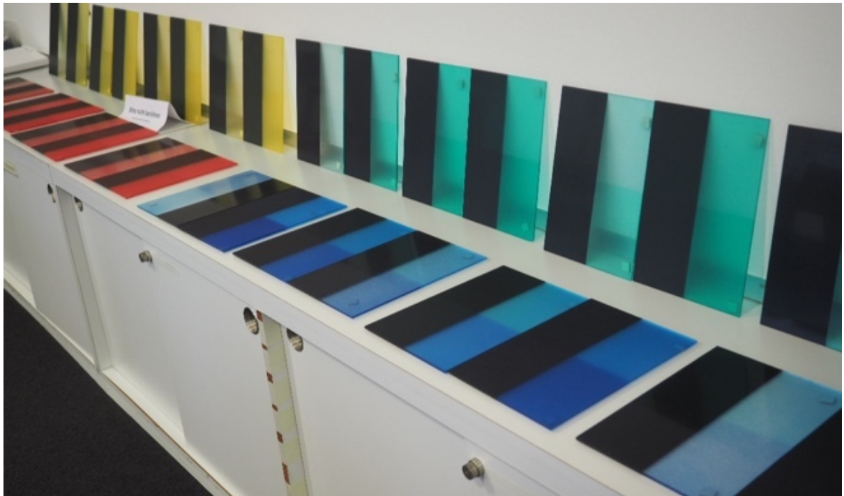
Abb.3: Glasmuster der ersten Testserie, partiell rückseitig dunkel beschichtet.
