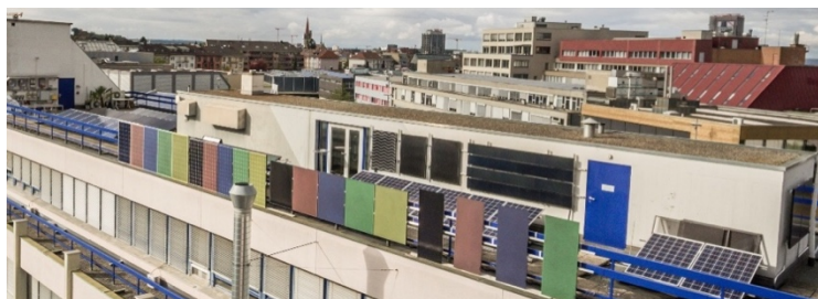
Abb.10: Farbige vollflächige PV-Panels im Test, Dachlabor Solvatec AG
