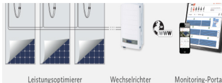
Abb.7: Aufbau der Testanlage auf dem Dachlabor bei Solvatec AG
