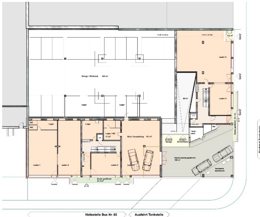
Abb.57 : MFH Dornacherstrasse Basel , Grundriss Erdgeschoss, Gewerbe / Tankstelle und Garage
