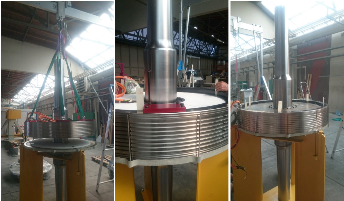
Abbildung 29: Platzierung Antrieb / Distanzhalter Rotor-Stator (rot) / Pitch Antrieb vor Deckelmontage
