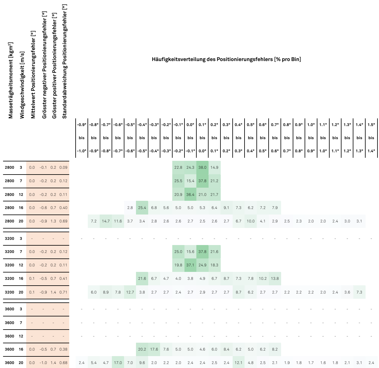
Abbildung 38: Häufigkeitsverteilung Positionierungsfehler mit Federlasten
