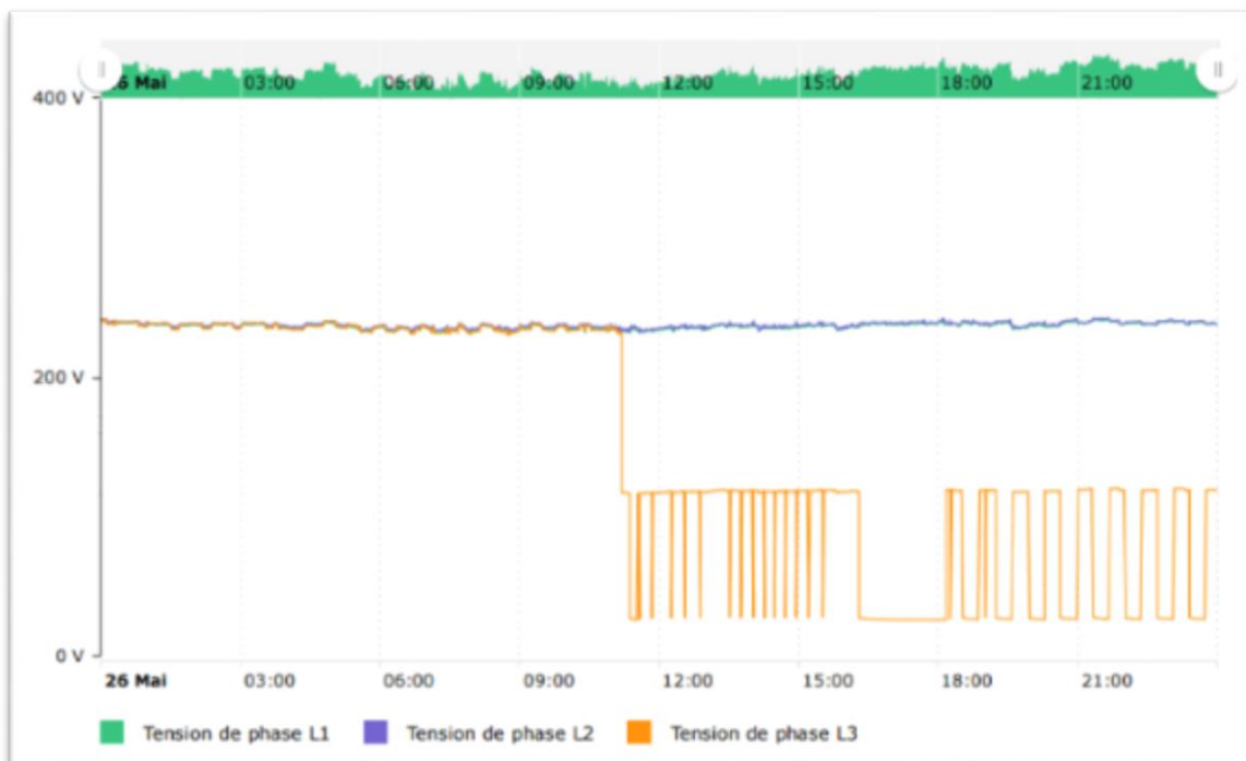
Figure 35 : Observation de la chute de tension de la phase 3 du bain de traitement 1 suite au fusible qui a sauté.
