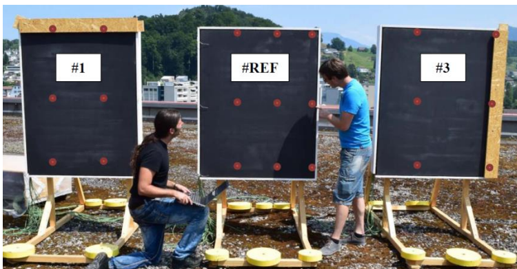
Abb. 8 Ansicht Versuchsaufbauten mit Messpunkten und Abschattungen (Quelle HSLU)
