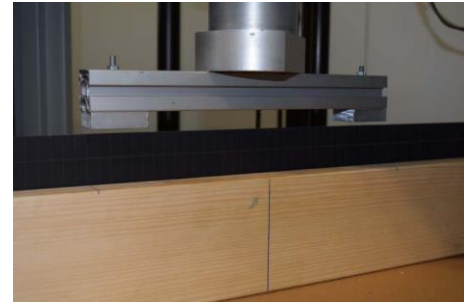
Abb. 9 Versuchsaufbau 4-Punkt Biegeversuch Glaskante. links schematisch, rechts real (Quelle HSLU)
