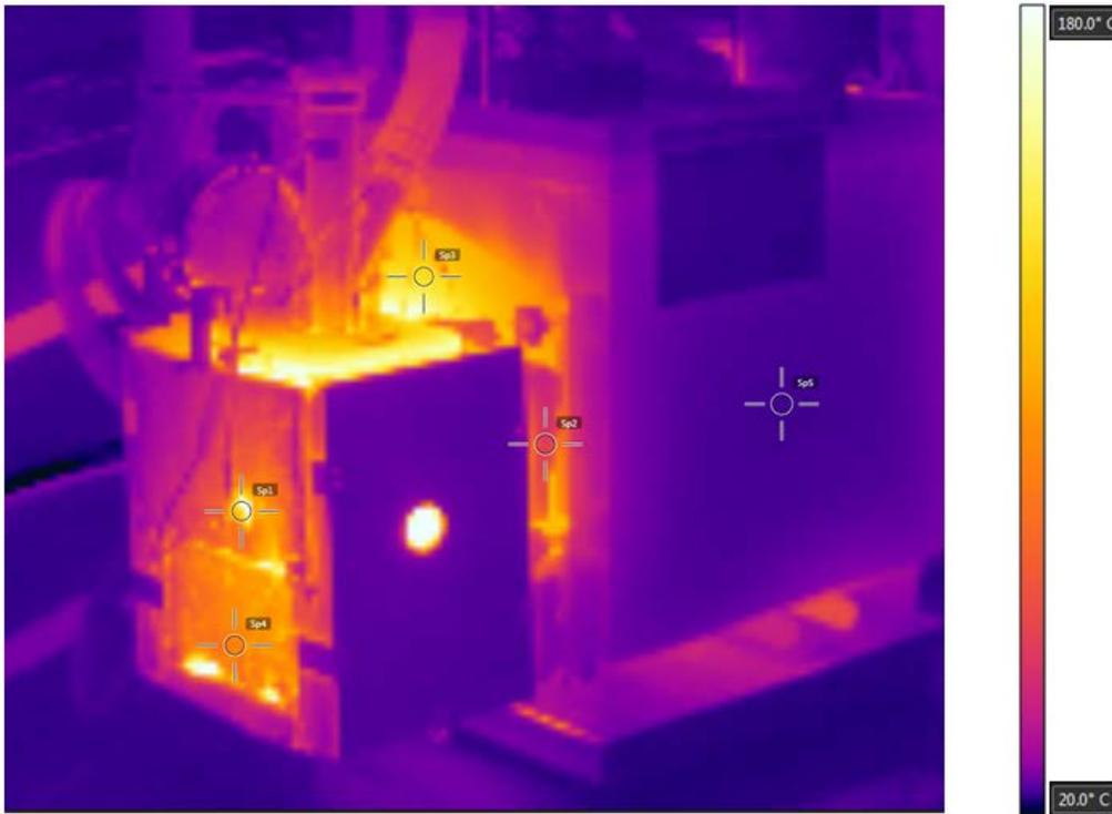
Abbildung 7 Wärmebildaufnahme HGB50 mit Isolation bei 38 kW
