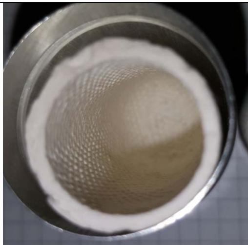
Abbildung 55 Staubfilter bei 15 kW und  $\lambda = 1.4$ . Sehr sauber keine Flugasche
