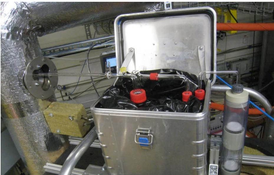
Abbildung 90 Kondensat-Messung im Abgasrohr
