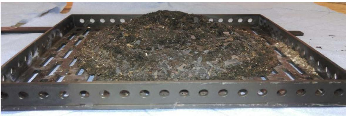
Abbildung 77 Verschlackung auf dem Rost nach drei Betriebsstunden
