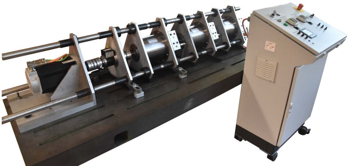
Figure 2.1 : Banc d'essais sur marbre avec les 3 types de moteurs et pupitre de commande
