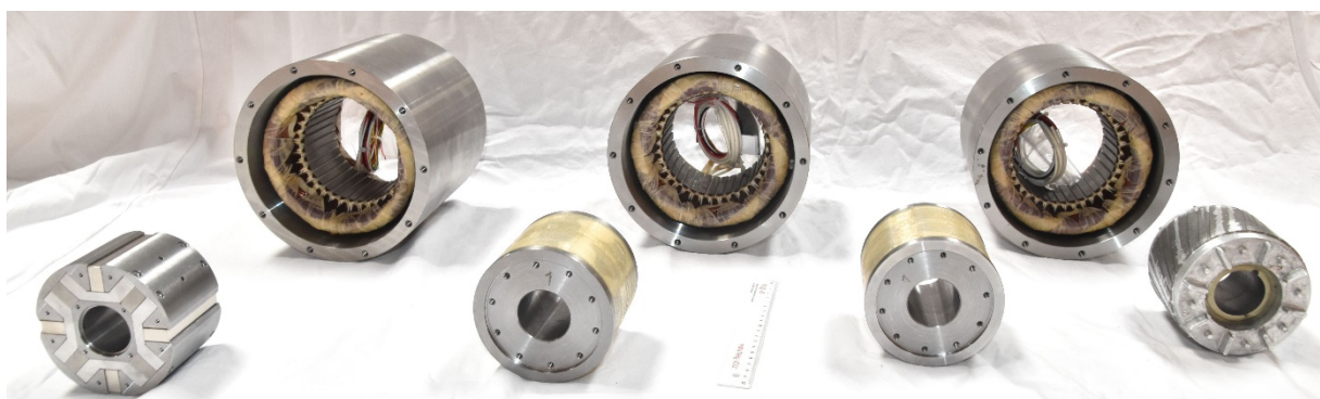
Figure 5.6 - Rotors, de gauche à droite: memory, synchrone type W, synchrone type M, asynchrone.
