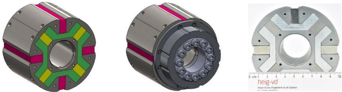
Figure 7 : Rotor du « memory motor » (avec et sans les flasques)
