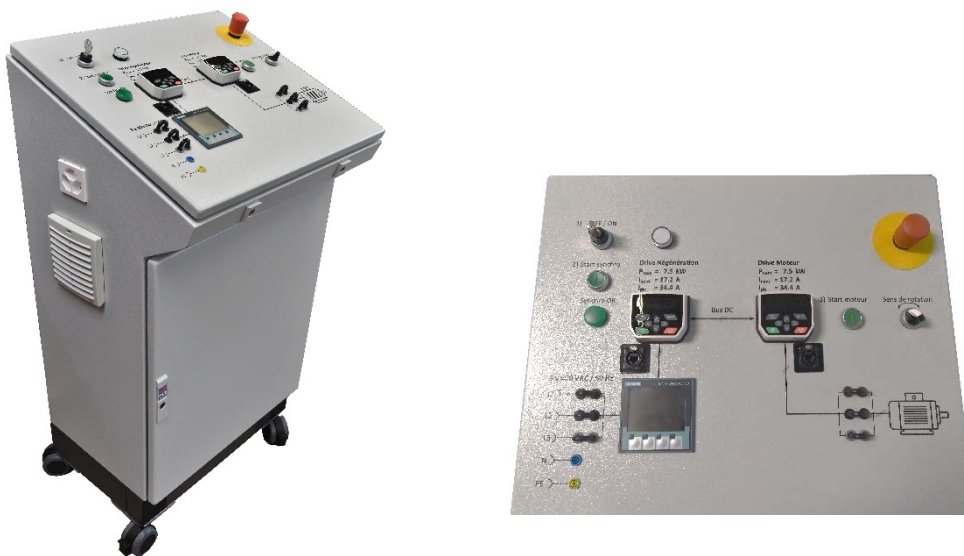
Figure 2.4 : Pupitre de commande du servomoteur Emerson
