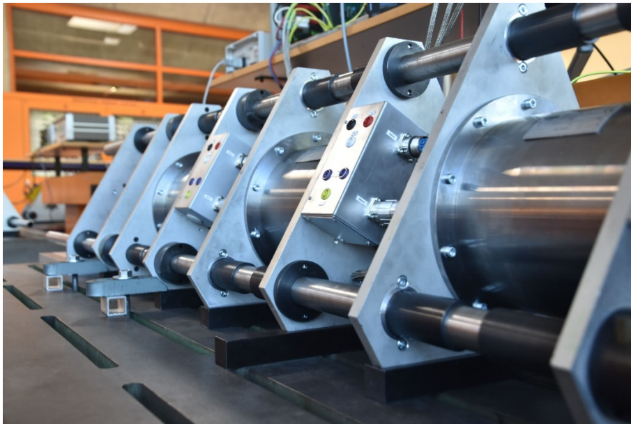
Figure 1.1 : Ensemble des moteurs testés montés sur un marbre
