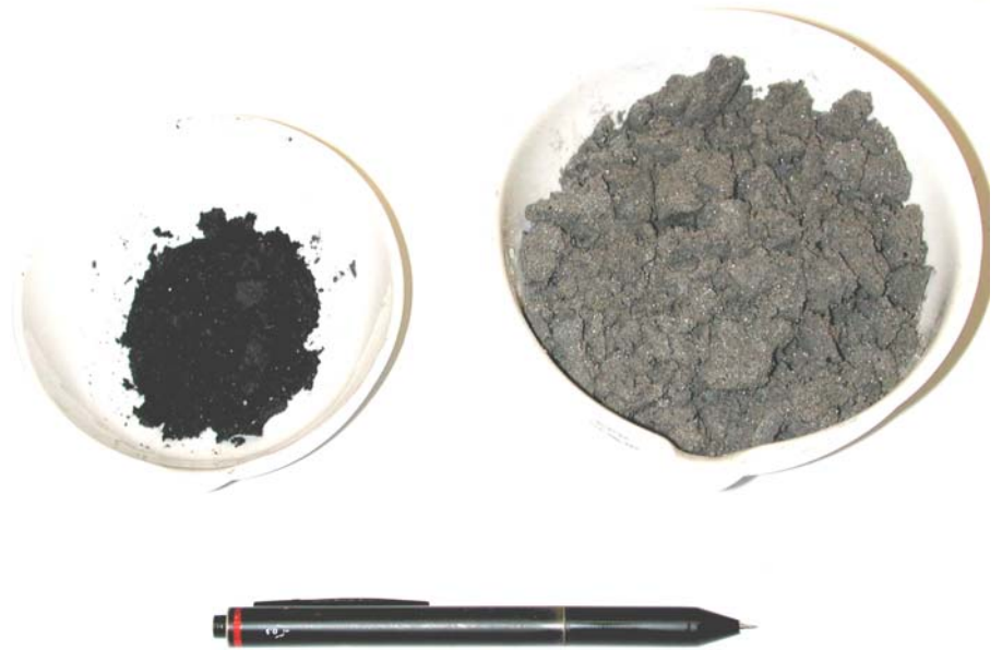
Abb. 1: Die beiden Produkte des exDIOX-Verfahrens: dioxinhaltiges Schadstoffkonzentrat (links) und sauberes mineralisches Material (rechts).
