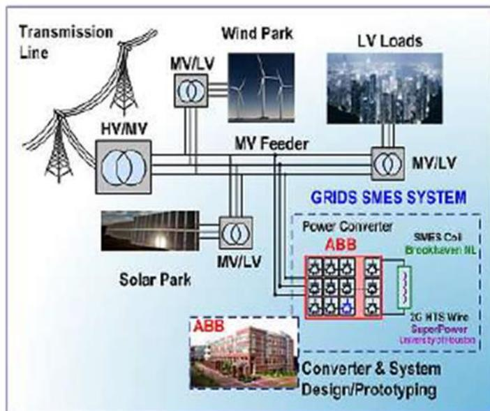
**Ziel:** 1.7 MWh SMES, direkt verbunden mit Leistungselektronik auf Si - Basis.
