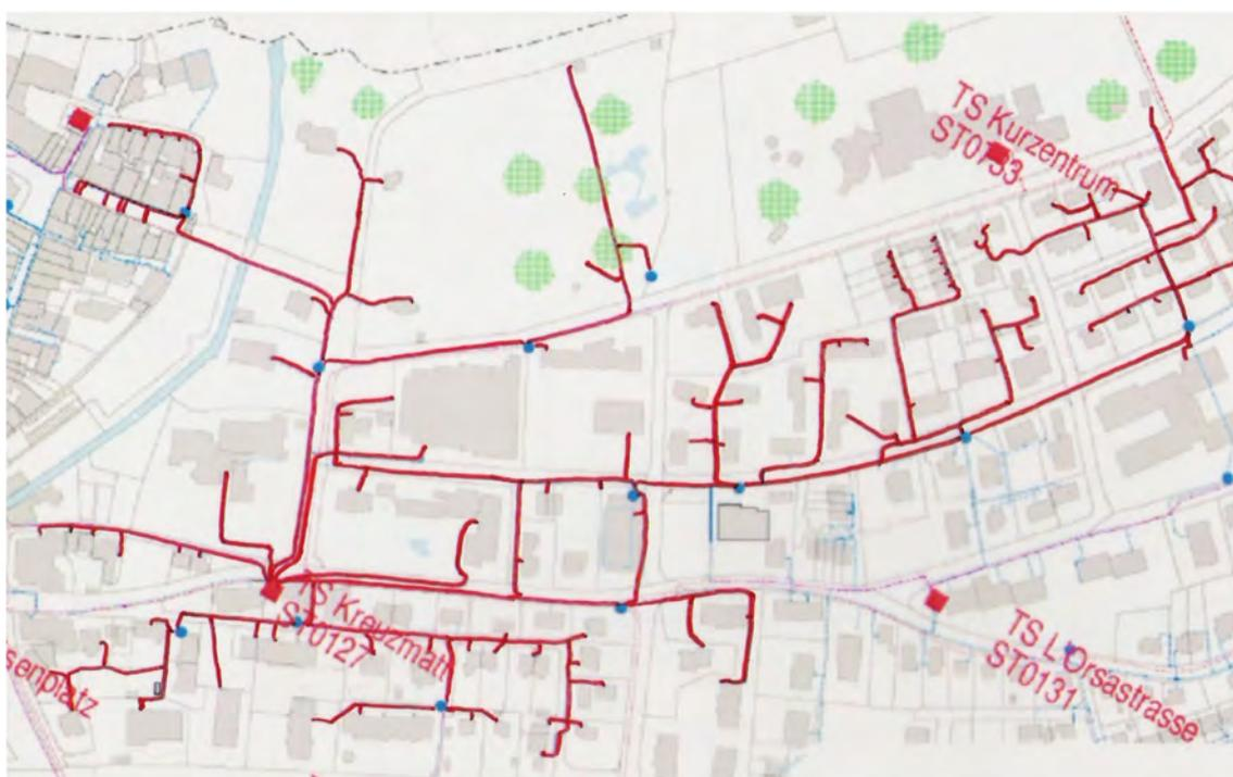
Abbildung 2: Struktur des VEiN NS-Netzes ab der TS Kreuzmatt.
