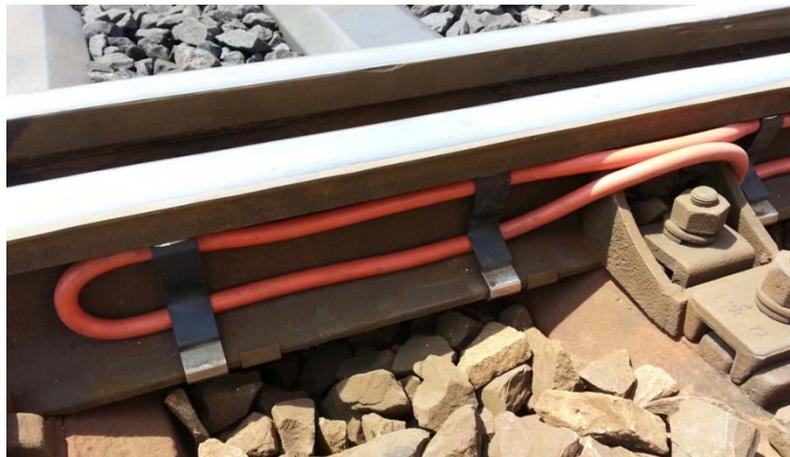
Abb. 19 Rundinduktoren der neuesten Generation (Systems SIMS, IFF GmbH, D)
