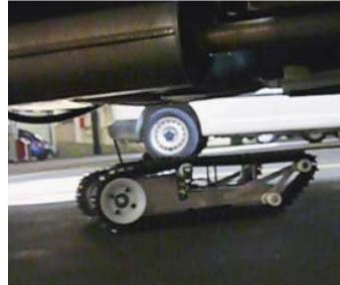
Durch geringe Bauhöhe unter Fahrzeugen einsetzbar
