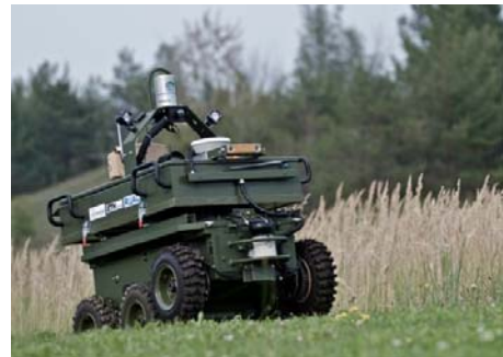
Das UGV ARTOR dient als Testplattform für die entwickelten Algorithmen
