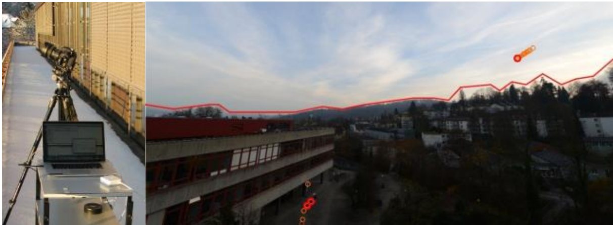
System mit hochauflösender Kamera (36MPixel), Weitwinkelobjektiv ca. 104° Azimut und Steuerungs- und Auswertungslaptop.
