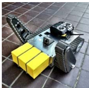
Cyclops4 EOD mit absetzbarer Sprengladung resp. Nutzlast (gelb)
