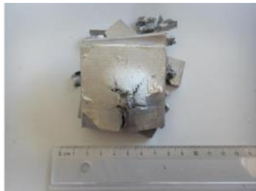
face arrière d'un composite à base d'aluminium après un essai balistique avec une balle 7.62x39 Lapua.
