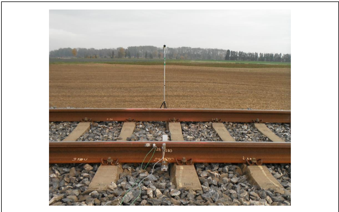
Abbildung B-6 Anordnung der Sensorik an MQ0 (km 24580)
