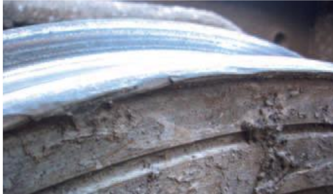
Abbildung 3: Überwalzung im Bereich der Fasse eines Eisenbahnrades [4]
