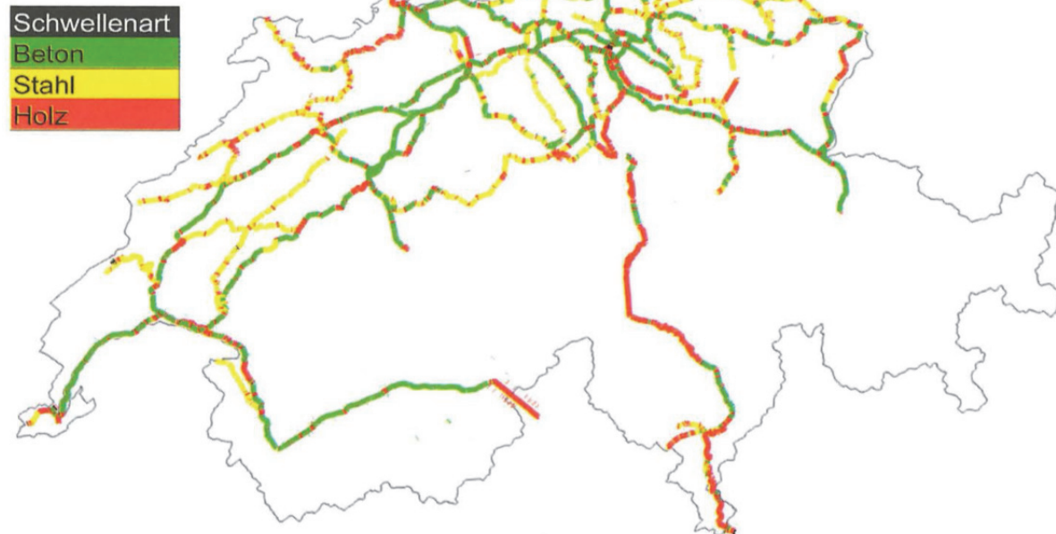
Abbildung 19: Aktuelle Oberbauform [Winklehner (2015)]
