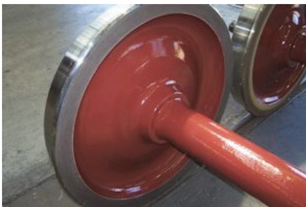
Abbildung 4: Beispiel für eine Radsatzbeschichtung Quelle: BASF-Coatings
